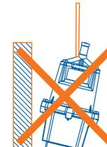
Não deixar a bomba suspensa pelo cabo elétrico, corda ou arame. Deve trabalhar suspensa apenas pela mangueira
