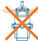
Não deixar a entrada da bomba fora d'água (deve ficar totalmente submersa)
