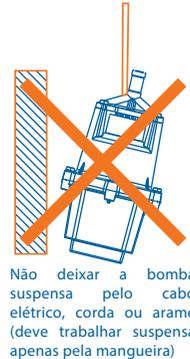
Não deixar a bomba suspensa pelo cabo elétrico, corda ou arame (deve trabalhar suspensa apenas pela mangueira)
