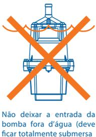
Não deixar a entrada da bomba fora d'água (deve ficar totalmente submersa)
